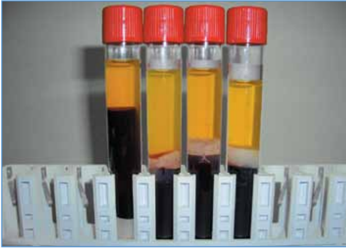
Abb. 34: Falsch zentrifugierte Trenngelröhrchen: Zentrifugengeschwindigkeit wurde nicht eingehalten. Von links nach rechts ansteigende G-Zahl, rechts korrekt zentrifugiertes Trenngelröhrchen.
